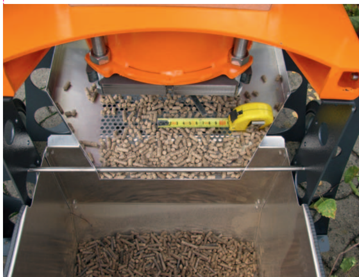
Beispiel geförderter Maßnahmen: Ecoworxx Pelletmaker für die Eigenherstellung von Dünger-, Einstreu- oder Futter-Pellets aus unterschiedlichsten Biomassen – Markteinführung mit Innovationsförderung des BMELV über die LR.
